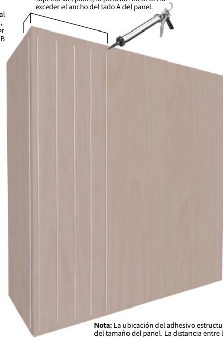
**Nota:** La ubicación del adhesivo estructural depende del tamaño del panel. La distancia entre los puntos de adhesivo debe ser razonablemente proporcional.
