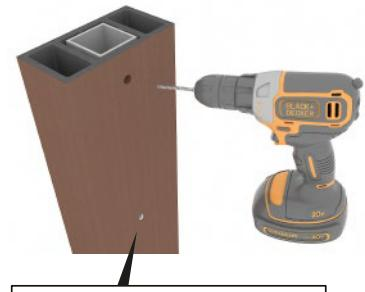
La distancia entre orificios debe ser la misma que la de la vigueta metálica
